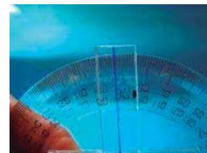
Figura 16.1. Muestra el transportador con su brazo de lectura ajustable.
