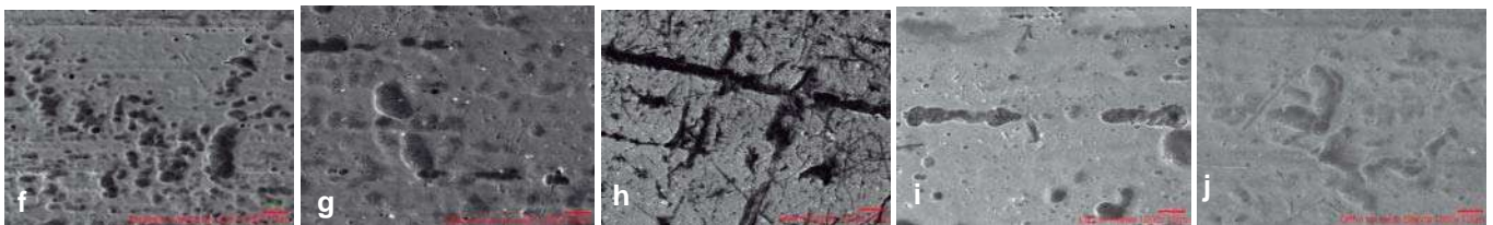
Fig. 8 f-j. Imágenes de los arcos recuperados después de haber estado 2 meses en boca mediante MEB a 1000X. f) Adenta g) Ah Kim Pech h) Borgatta, i) Lancer, j) Ortho Technology,
