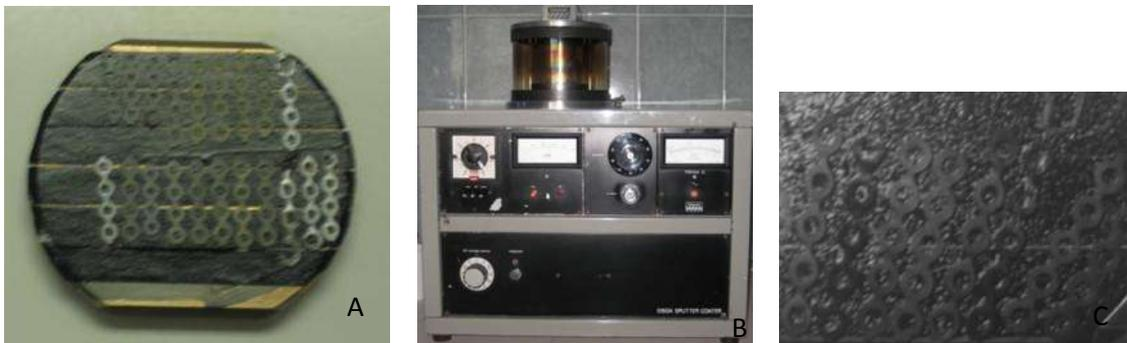
Figura 16. A) Las cadenas antes de ser metalizadas en el porta muestras B) Metalizador C) Ligas metalizadas con una ligera capa de cobre.
