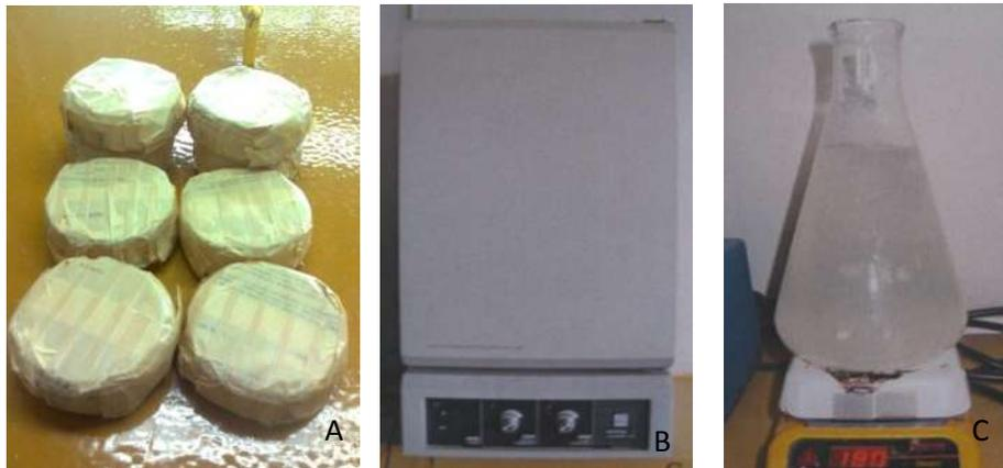
Figura9. A) Cajas de petri con papel estraza B) Mufa para esterilizar C) Caldo para ser llevado a esterilizar.
