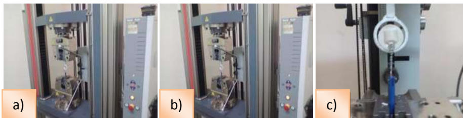
Fig.6 a) Se observa la colocación de las muestras de la resina. b) Se observa la colocación de las muestras de del ionómero de vidrio. c) Se muestra el momento de la medición de la fuerza de las muestras.
