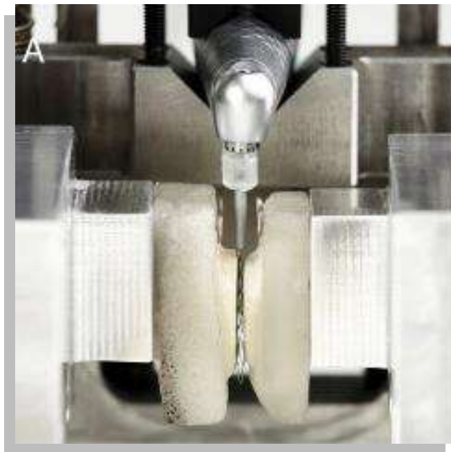
Figura XXV. Equipo usado para medir la abrasividad de la lima SAF: se colocaron 2 porciones de diente en un dispositivo de precisión a 0.2 mm de distancia una de la otra. Se operó una lima SAF entre dos plataformas, la dentina removida se calculó pesando las muestras antes y después del proceso (Hof, 2010).
