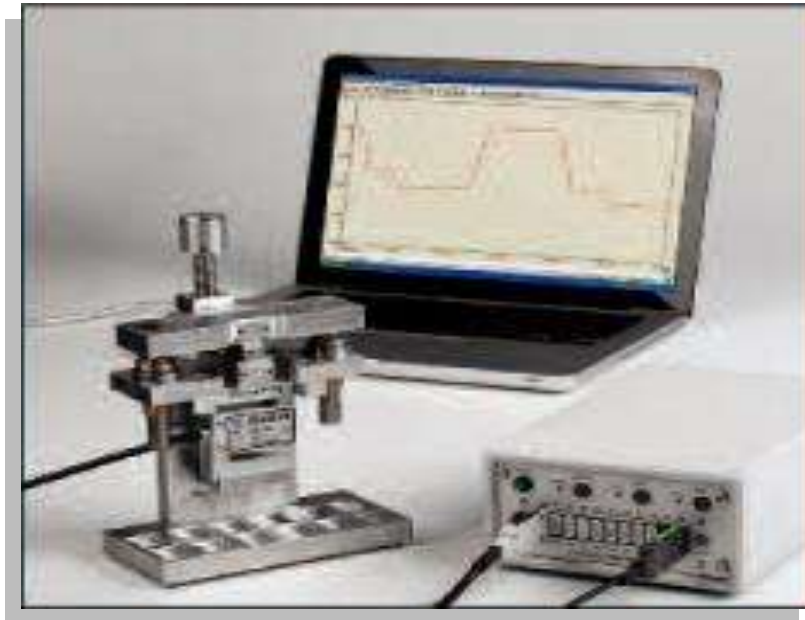
Figura XXIII. La fuerza generada por la lima comprimida se registró por medio de un sistema computarizado (Metzger, 2011).
