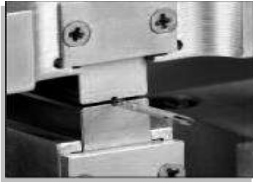
Figura XXII. Equipo para la medición de la fuerza circunferencial: una lima SAF se insertó en un canal entre una plataforma superior e inferior. El diámetro del canal fue de 0.2 a 1.0mm (Hof, 2010).
