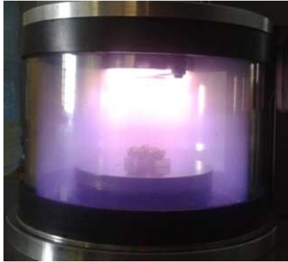
Figura 31.- Momento de la metalización de las piezas para su estudio. ; fuente propia.
