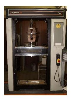
Fig. 10 Máquina Universal marca Instron modelo 5500R
