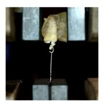
Fig. 16. Ketac Cem 3M muestra 02. Deformación del gancho con extrusión del material y desprendimiento del dispositivo intraconducto.
