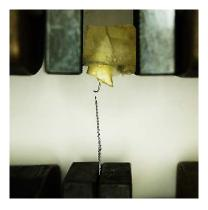
FIG 13. Temp Bond NE muestra 01. Ocurrió una extrusión de material y deslizamiento del dispositivo, sin embargo no se llegó al desprendimiento por la deformación del hélix.
