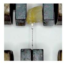
Fig. 14 Prevision Cem muestra 01. Desprendimiento del dispositivo con extrusión de material.
