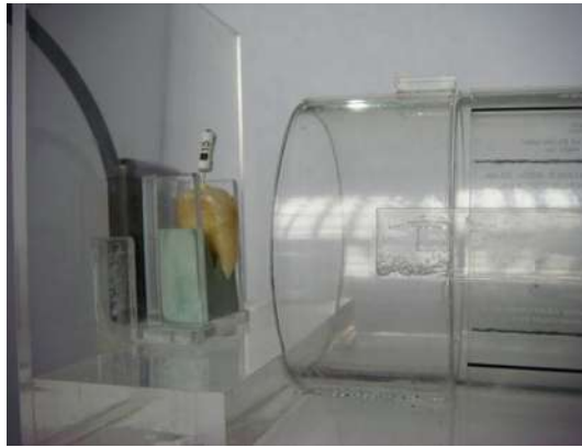
Figura 23. Dispositivo de acrílico (diseñado por la autora), que se adaptó al tubo del aparato de Rayos X ( Corix 70 Plus a 70 kV y 9 mA ) y al sensor del Radiovisógrafo ( Kodak 2100 ).
