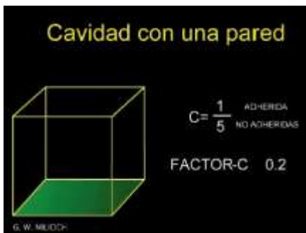
Fig.17. Muestra una cavidad con una pared adherida, donde obviamente no existe stress, teniendo un Factor C favorable de 0.2.
