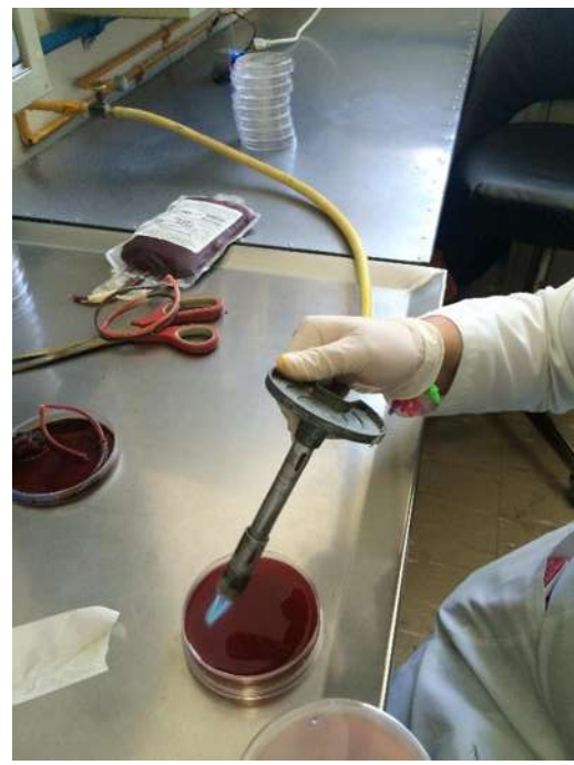
Ilustración 13 aplicación de calor para retirar burbujas
