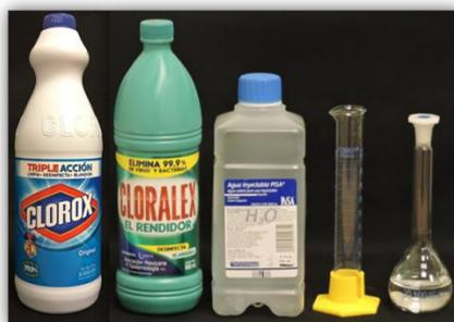
Figura 1. Preparación de disoluciones de NaOCl de uso doméstico.
