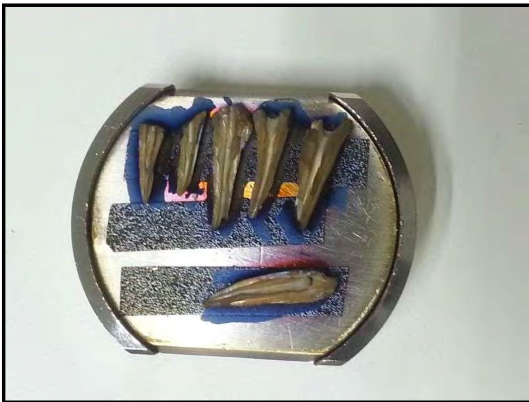
Figura 21. Muestras listas para ser observadas por Microscopia Electrónica de Barrido (fuente propia)
