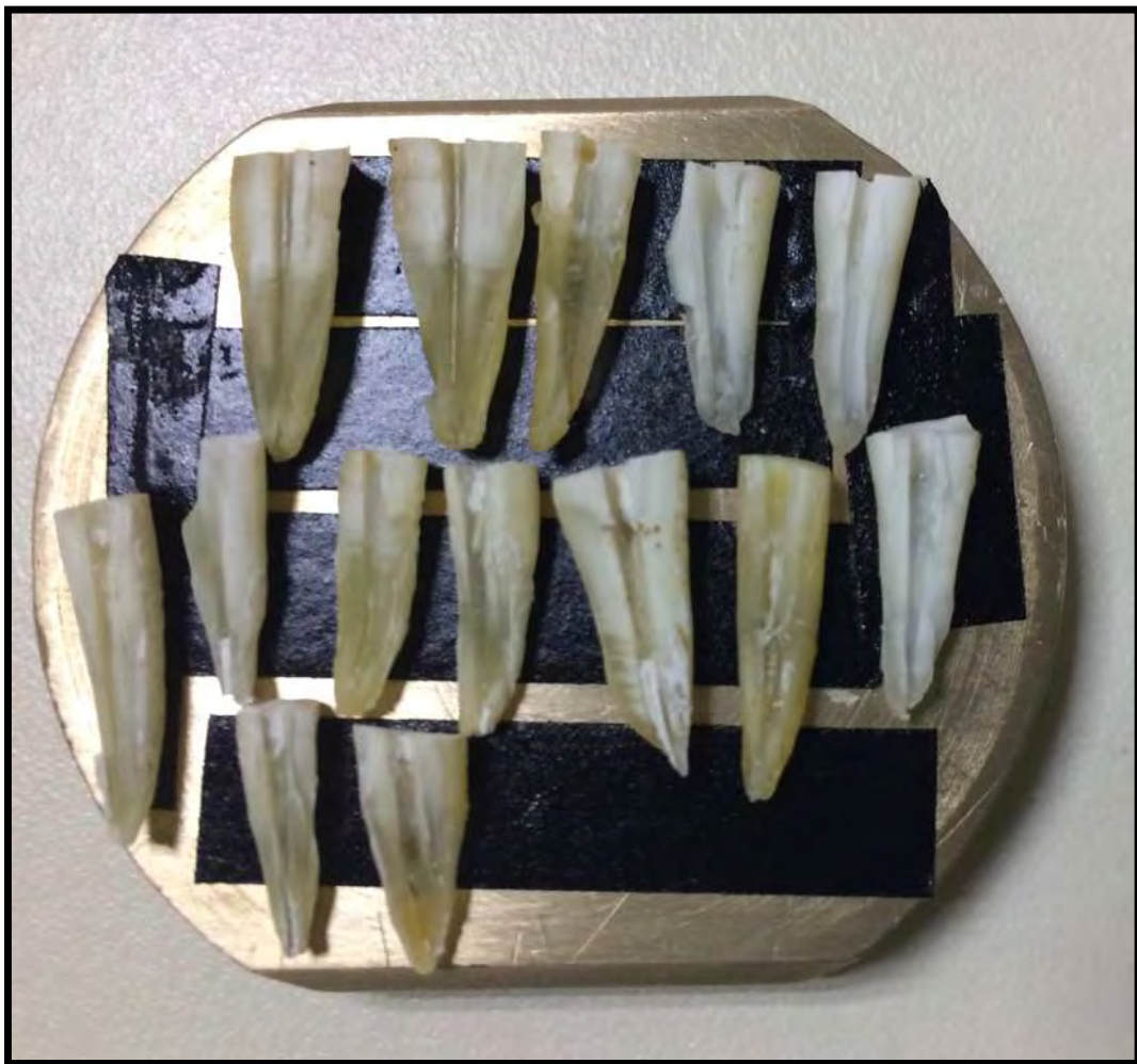
Figura 18. Porta muestras Cu-Zn con muestras Biológicas (fuente propia)
