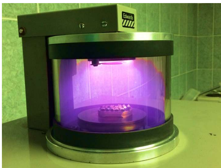
Figura 20. Proceso de metalización (fuente propia)
