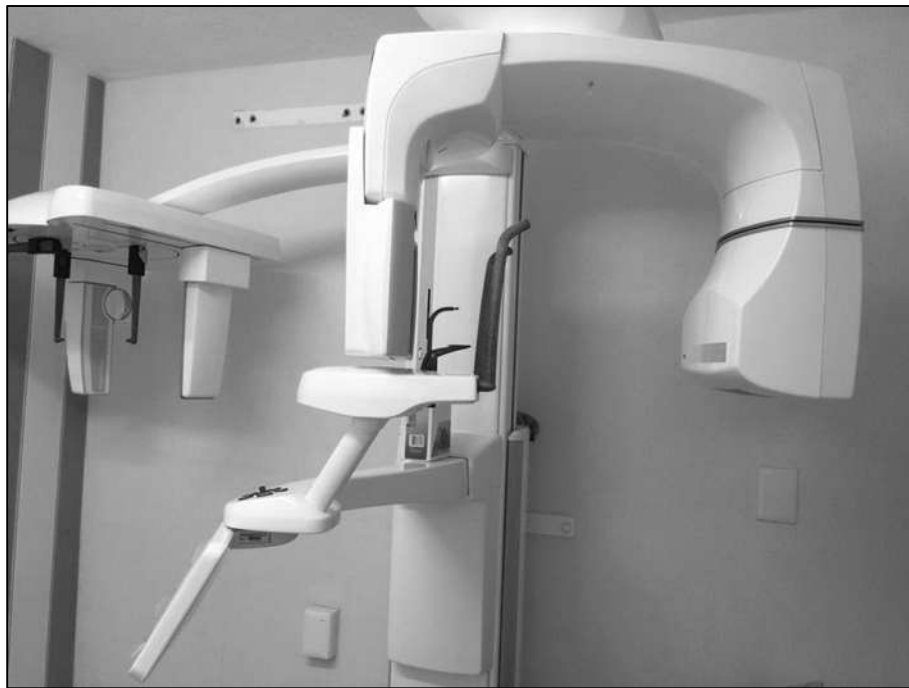
Figura 17. Equipo de tomografía computarizada de haz cónico tridimensional. Fuente: Propia
