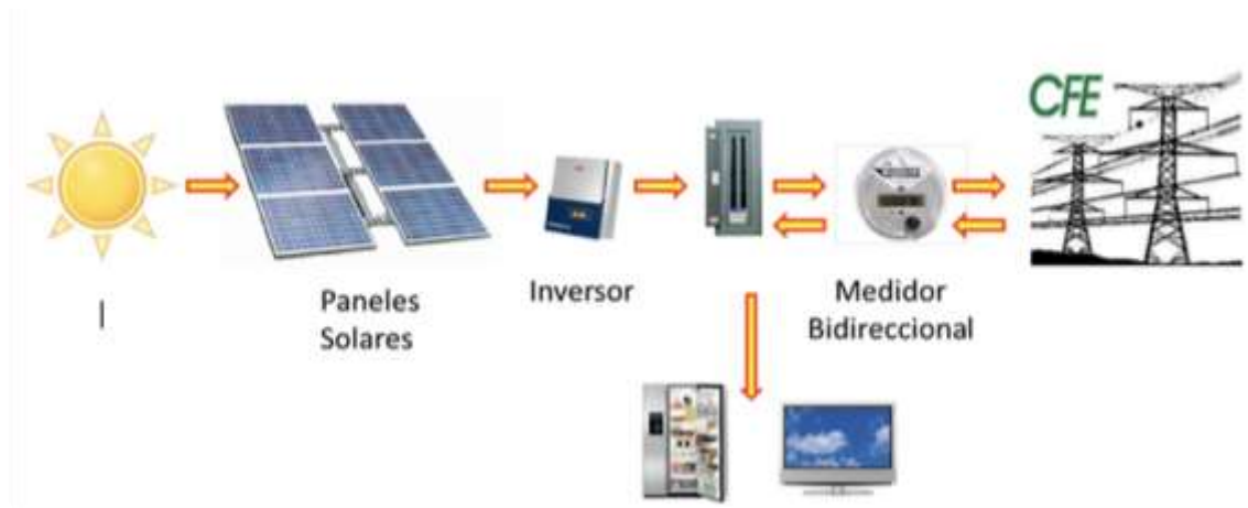
Figura 6. Sistema fotovoltaico interconectado a la red. Fuente: Grupo Solarmex
