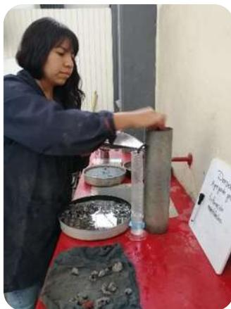
Fig. 30 Desalajo de agua del picnómetro a la probeta
