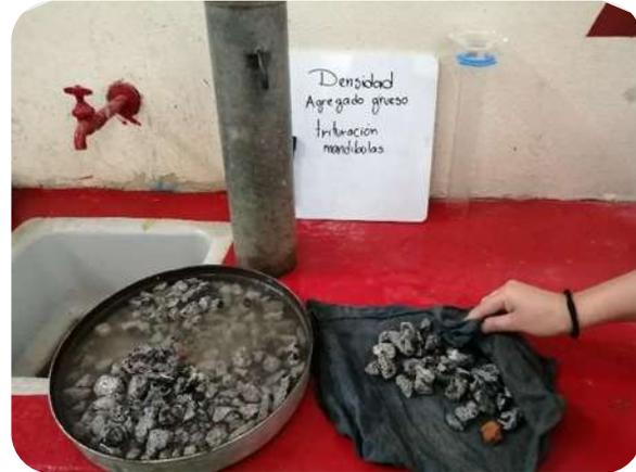
Fig. 29 Secado superficial del RCA
