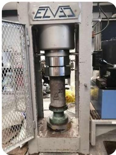
Fig. 37 Acomodo del espécimen en la prensa eléctrica
