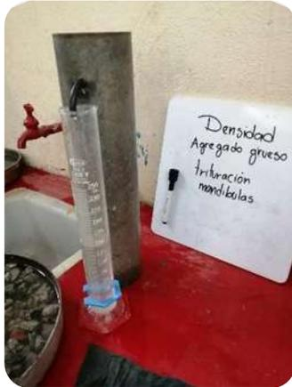
Fig. 28 Medición de la densidad
