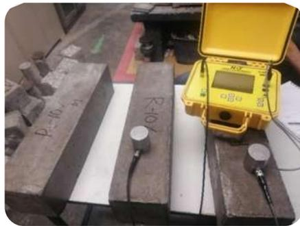
Fig. 35 Aparato para la medición de velocidad de pulso
