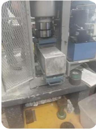
Fig. 39 Acomodo de la viga en la máquina de pruebas
