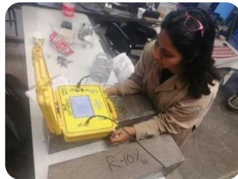
Fig. 36 Medición directa de VPU
