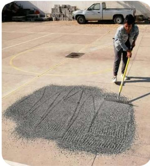
Fig. 20 Extendido de material para secado
