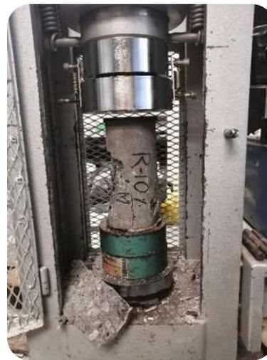
Fig. 38 Falla de la muestra a compresión
