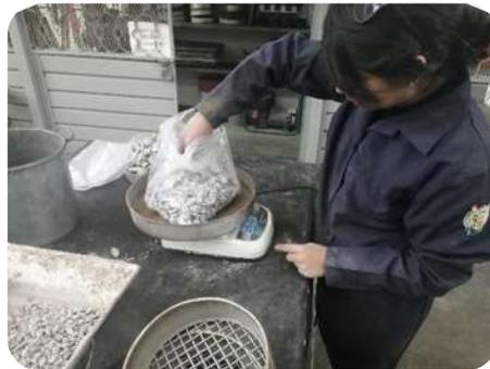
Fig. 33 Pesado de las muestras de material
