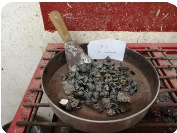
Fig. 24 Evaporación del agua en el agregado
