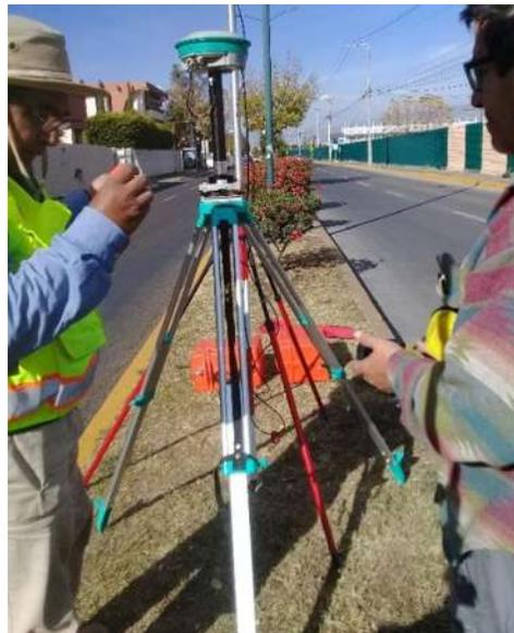
Figura 22. Equipo GPS RTK.
