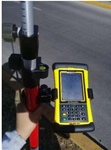
Figura 23. Colector de datos móvil de equipo GPS.
