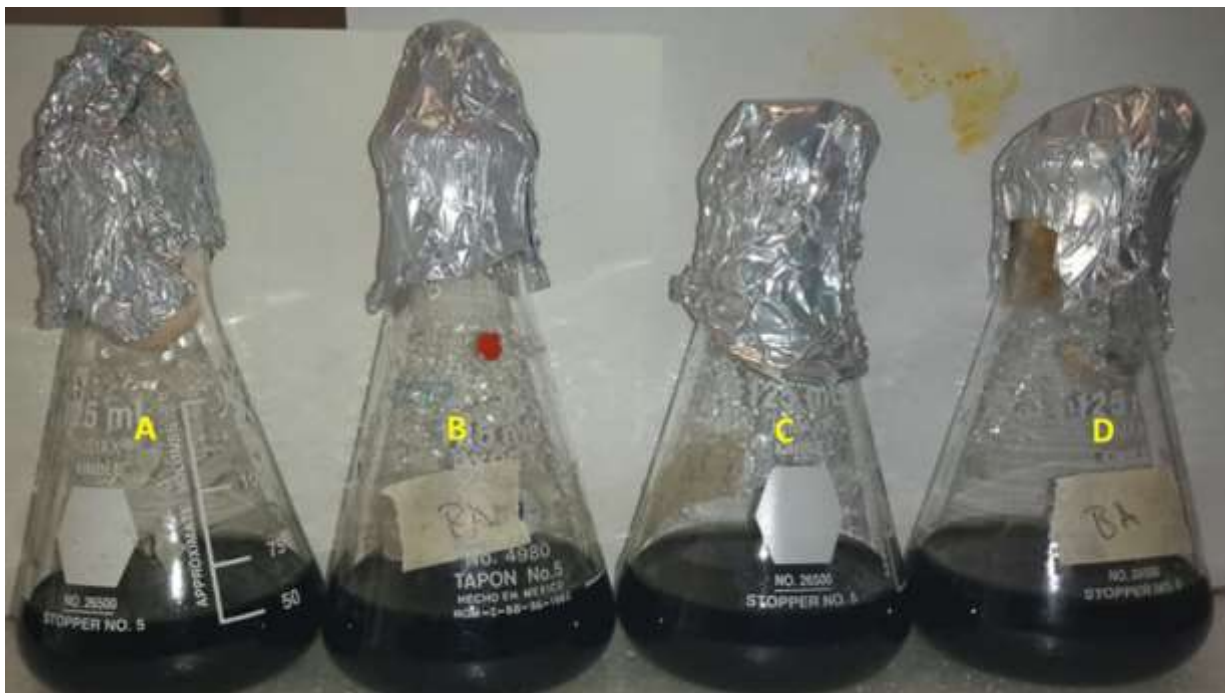
Foto 5. Cinética de decoloración de AGA8. A) 300 mg/L pH5.2, B) 300 mg/L pH 8.6, C) 500 mg/L pH 5.2 D) 500 mg/L pH 8.6.
