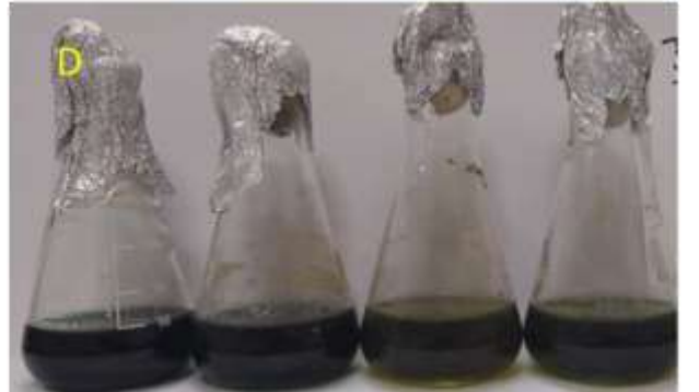
Foto 2. Cinética de decoloración T. versicolor + B. xenovorans . A) 300 mg/L pH 5.2, B) 500 mg/L pH 5.2, C). 300 mg/L pH 8.6, D) 500 mg/L pH 8.6
