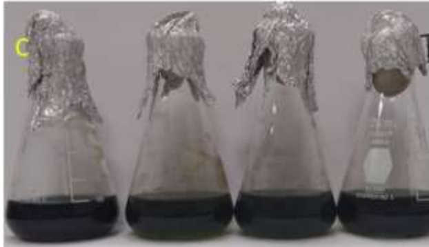
Foto 2. Cinética de decoloración T. versicolor + B. xenovorans . A) 300 mg/L pH 5.2, B) 500 mg/L pH 5.2, C). 300 mg/L pH 8.6, D) 500 mg/L pH 8.6
