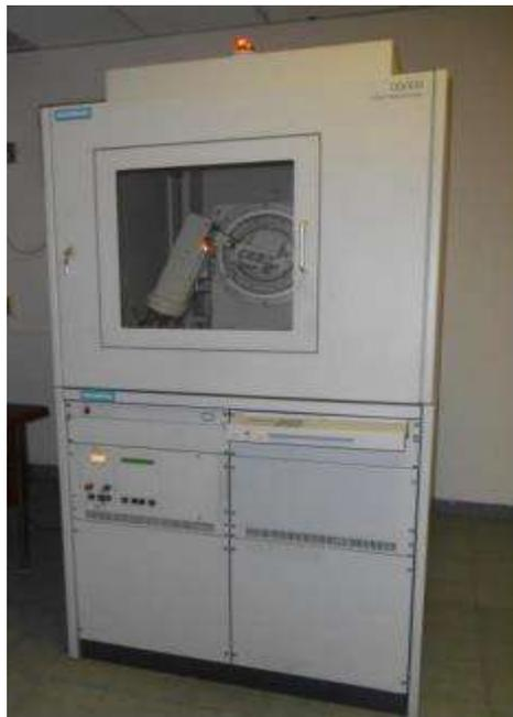
Para llevar a cabo cada análisis, se molieron los polvos de los catalizadores a un tamaño inferior a 200 mallas ( $74 \mu\text{m}$ ); se colocaron en el porta muestras y se introdujeron en el aparato. Las condiciones de operación fueron con un tamaño de paso de  $0.6 \theta^\circ$  en un intervalo de análisis de  $10\text{-}80^\circ$ . A un voltaje de 40 KeV y una corriente de 30 mA.
