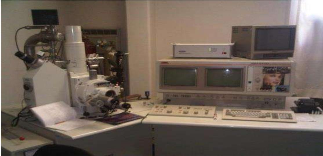
Antes de introducir la muestra a analizar se realizó un recubrimiento metálico con cobre para que haya conductividad eléctrica. Una vez metalizadas, las muestras se adhirieron con cinta de carbono en un porta muestras para finalmente ser introducidas en el microscopio.
