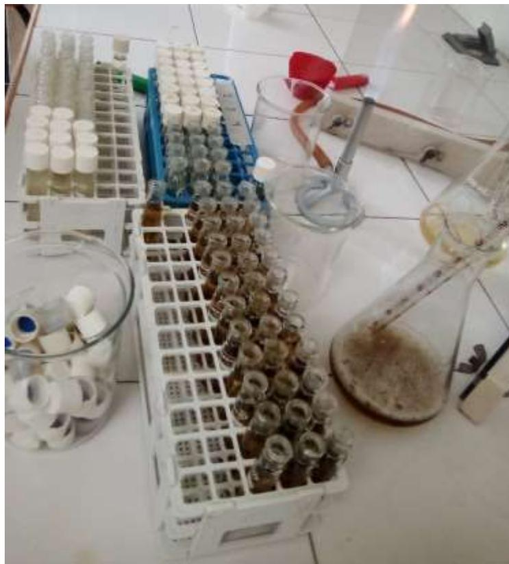
**FIGURA 14.** Determinación de coliformes fecales y totales, con la técnica de tubos múltiples.
