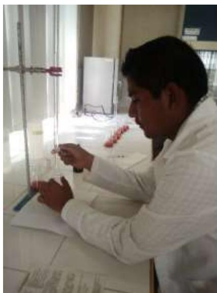
**FIGURA 12.** Determinación de parámetros físico-químicos con técnica de titulación.
