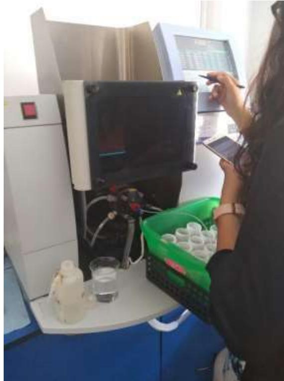
**FIGURA 15.** Determinación de metales pesados (elementos traza) Y Iones mayoritarios.
