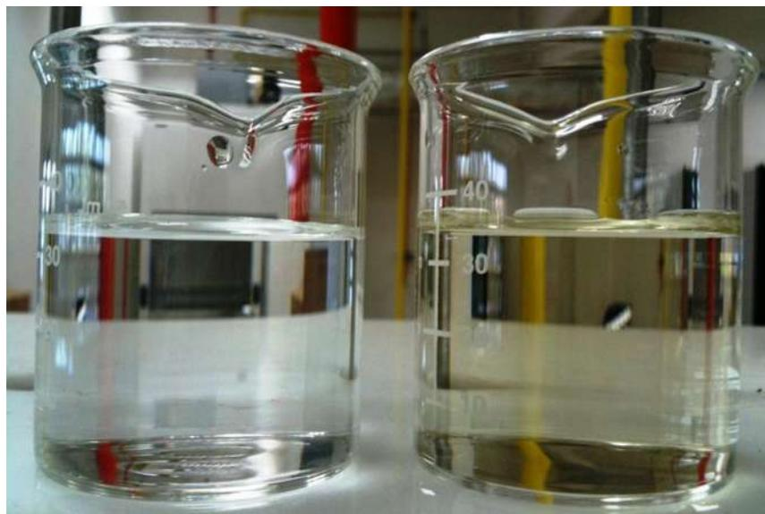
Figura 36. Soluciones de la reacción obtenida tras la degradación de AA9. De lado izquierdo, la solución de reacción obtenida por Degussa P25. De lado derecho con un color cobrizo, la solución de reacción obtenida con Aldrich.
