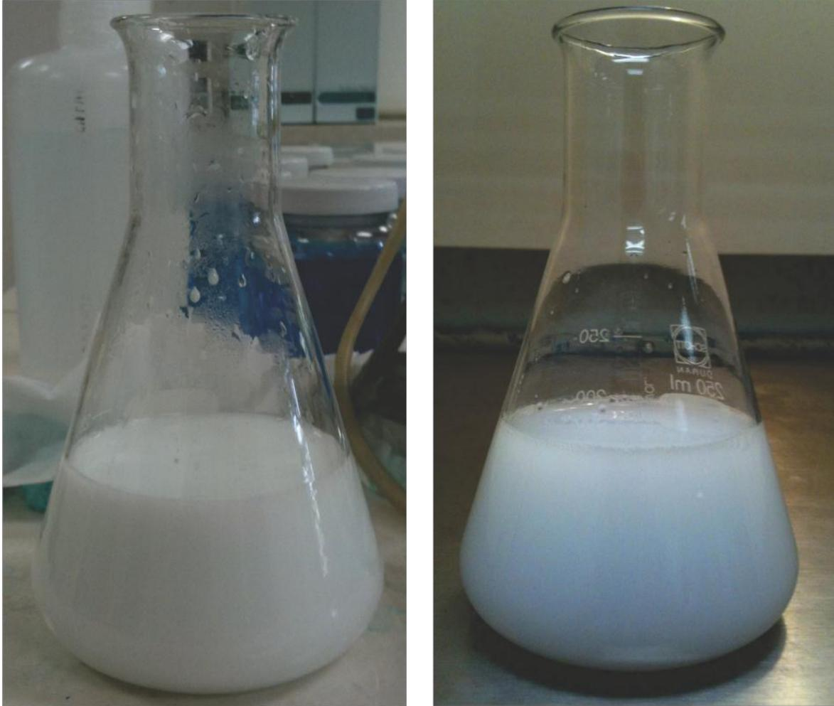
Figura 32. Aspecto de las suspensiones de catalizador después de haber degradado el colorante. De izquierda a derecha: Aldrich y Degussa P25.
