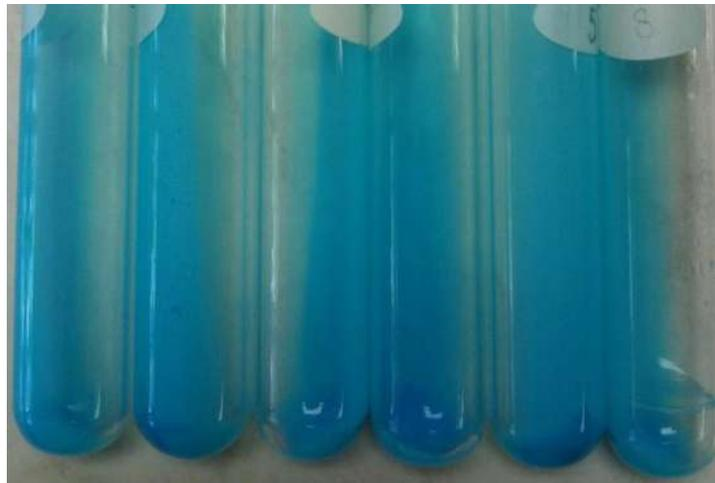
Figura 57. Remanentes de  $\text{TiO}_2$  teñidos de azul por efecto de la adsorción.
