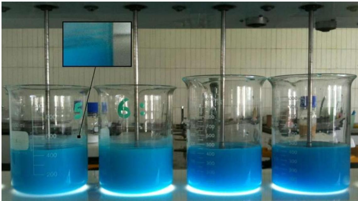
Figura 50. Pruebas de adsorción realizadas en un equipo de jarras.
