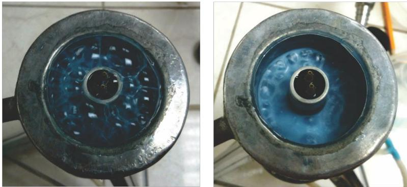
Figura 34. Formación de espuma con el catalizador Degussa P25 (izquierda), para Aldrich solo se observa el burbujeo (derecha).
