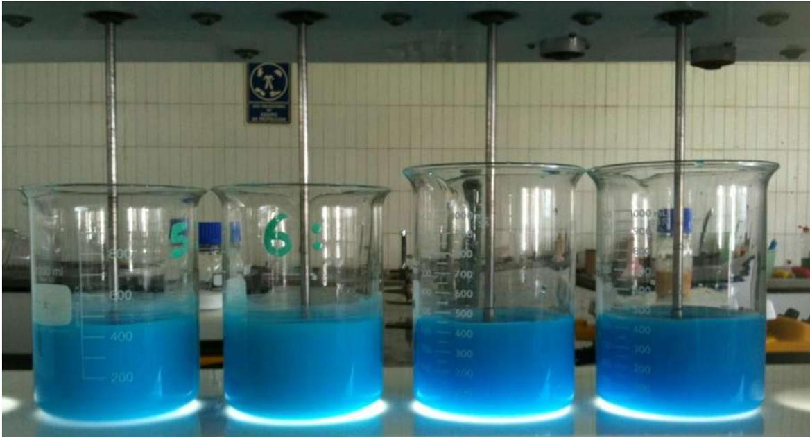
Figura 29. Agitador de propelas
