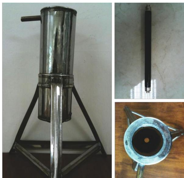
Figura 22. Reactor tipo batch y lámpara de luz UV
