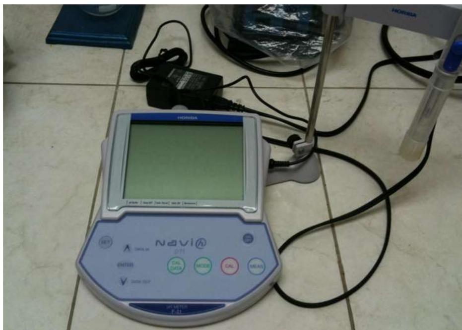
Figura 24. Potenciómetro Horiba F-51
