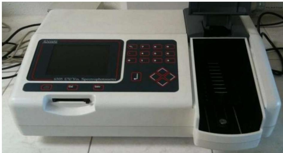
Figura 23. Espectrofotómetro - 6505 UV/Vis., Jenway
