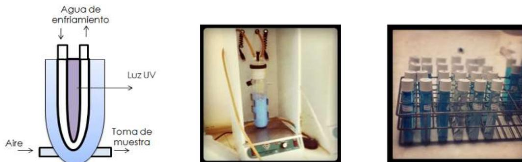
Figura 32. Fotorreactor energía UV.
