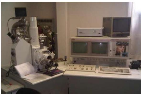
Figura 22. Microscopio Electrónico de Barrido JSM-6400 JEOL Noran Instruments.
