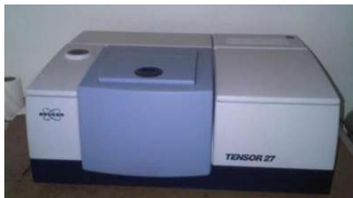
Figura 28. Equipo de espectroscopia de infrarrojo marca Bruker modelo Tensor 27.
