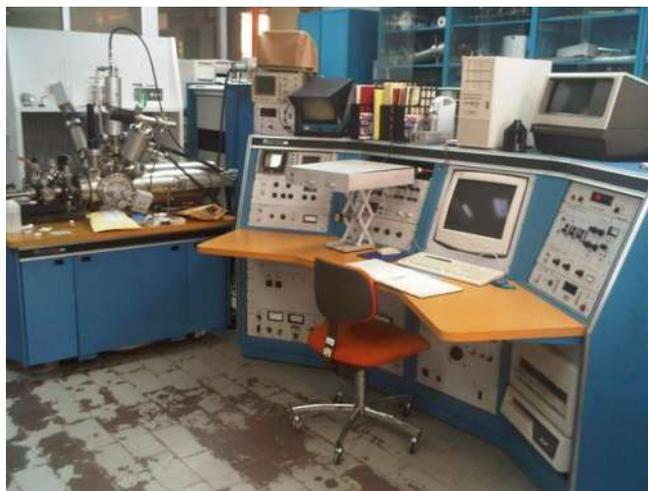
Figura 30. Equipo de XPS ESCA-SAM de Perkin-Elmer modelo 560.
