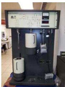
Figura 27. Equipo para la medición del área superficial específica marca QUANTACHROME.
