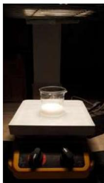
Figura 33. Fotorreactor de luz visible.
