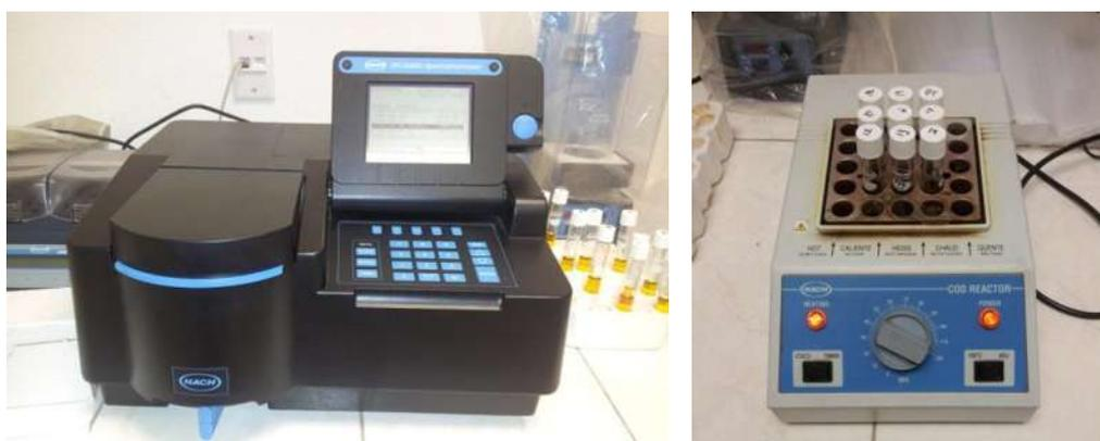
Figura 34. Espectrofotómetro y Reactor de DQO. Marca Hach.
