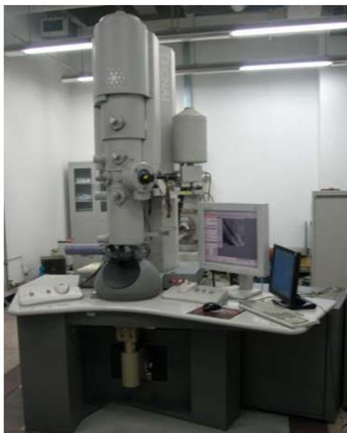
Figura 29. Microscopio electrónico de Transmisión Philips Tecnai TF-20.
