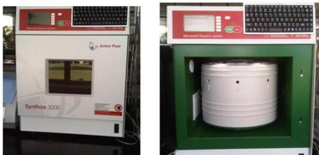
Figura 20. Reactor de microondas marca Anton Paar modelo Synthos 3000.
