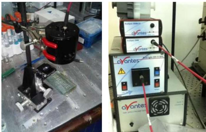
Figura 31. Equipo de Espectroscopia UV-Vis marca Avantes.
