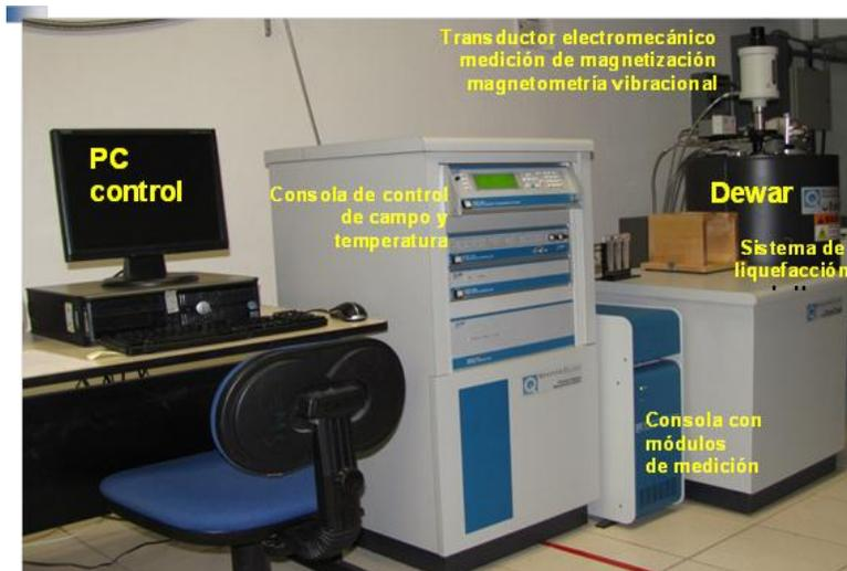
Plataforma de medición de propiedades físicas de la firma Quantum Design PPMS® EverCool®-9T.
