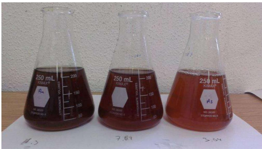
**Figura 20.** Efecto visual del pH en la coloración del efluente.
