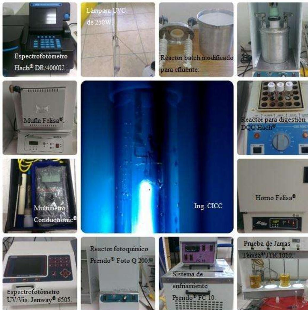
**Figura 14.** Equipo en general utilizado para la realización del proyecto.
