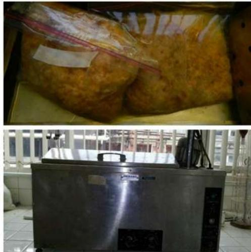
**Figura 12.** Baño Termostático para blanqueo de Pulpa.
