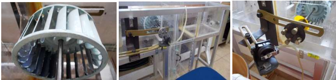
Figura 58. Instalación del Acoplamiento Mecánico.
