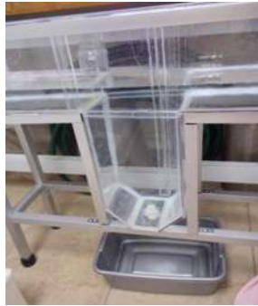
Figura 57. Canal Abierto a Prueba de Fugas.
