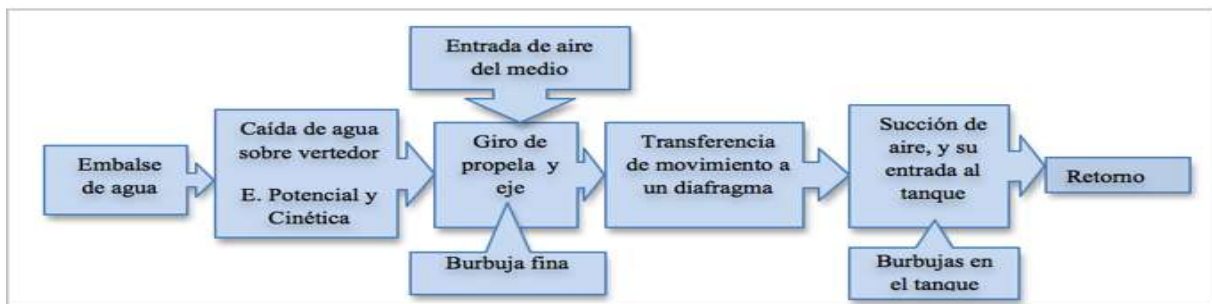
Figura 11. Esquema General del Proceso de Transferencia de Masa y Energía.
