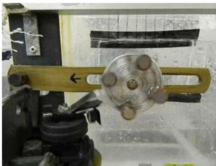
Figura 14. Acoplamiento Mecánico Eje-Diafragma.
