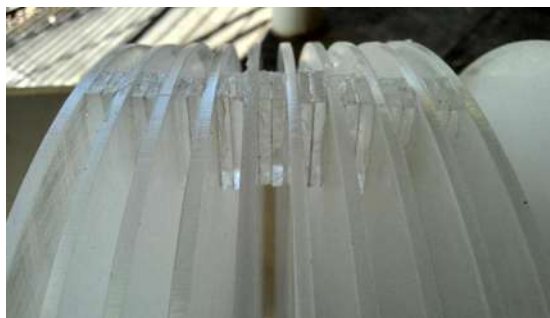
Figura 5.11 Colocación de los separadores rectangulares de acrílico.
