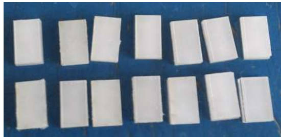
Figura 5.10 Separadores de discos de acrílico de 1.5 cm x 2.5 cm
