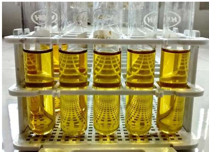
Figura 9 Disoluciones de la curva de calibración de Standard Methods en concentración ascendente (izquierda a derecha)
