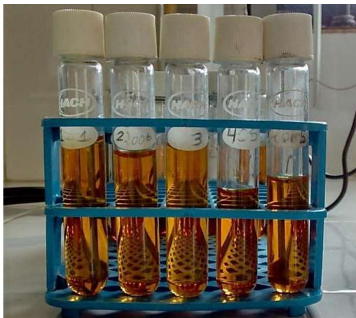
Figura 7 Muestras para la curva de calibración de la NMX-030-SCFI-2001 después de la digestión. Observar la fuga en los tubos 4 y 5
