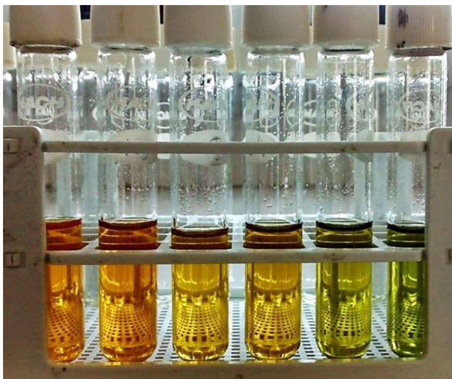
Figura 12 Coloración de las disoluciones para la curva de calibración (de menor a mayor concentración) y el blanco de reactivos (tubo 1 izquierdo) para la NMX-AA-030/2-SCFI-2011
