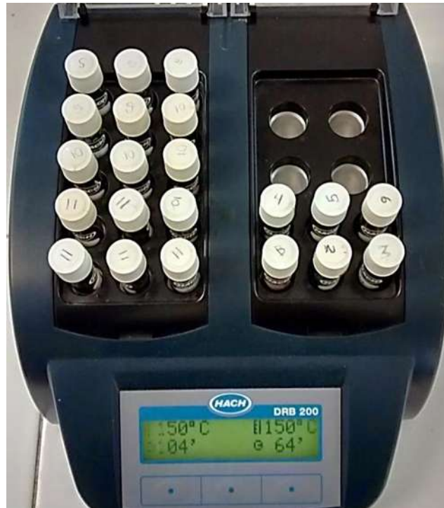
Figura 16 Disoluciones en digestión de la curva de calibración (derecha) y de la muestra de DQO propuesta para los 3 métodos (izquierda)
