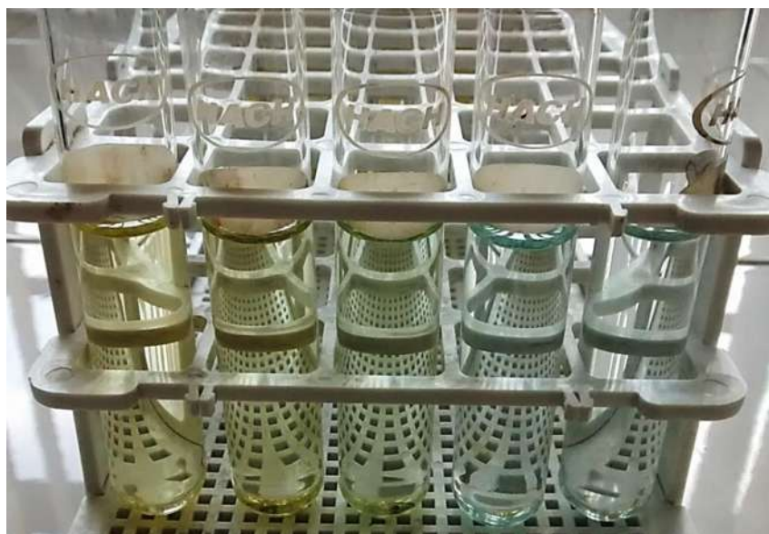
Figura 18 Tubos de la curva de calibración para intervalo bajo de mayor a menor concentración de izquierda a derecha
