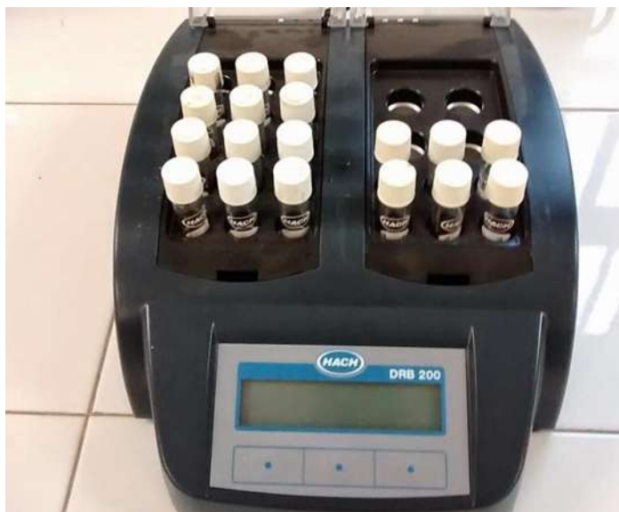
Figura 4 Soluciones de la curva de calibración y blanco a la derecha, soluciones de muestra a digerir a la izquierda
