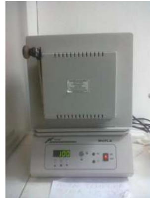
Figura 6. Mufla para determinación de sólidos
