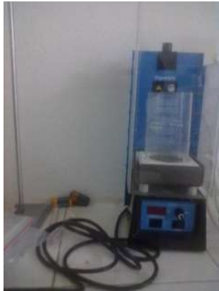
Figura 5. Equipo de digestión para N_{TK} , Digesdhal
