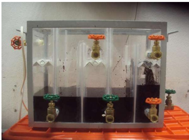
Figura 16. Inoculación del reactor
