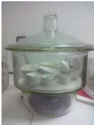
Figura 7. Desecador para enfriamiento de las muestras
