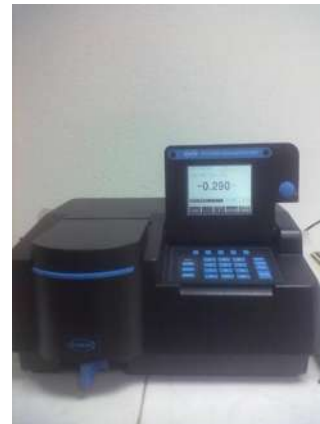
Figura 8. Espectrofotómetro Hach DR 4000U, para lectura de diferentes parámetros
