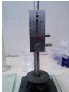
Figura 3.8.1 Determinación de tiempo de fraguado.
