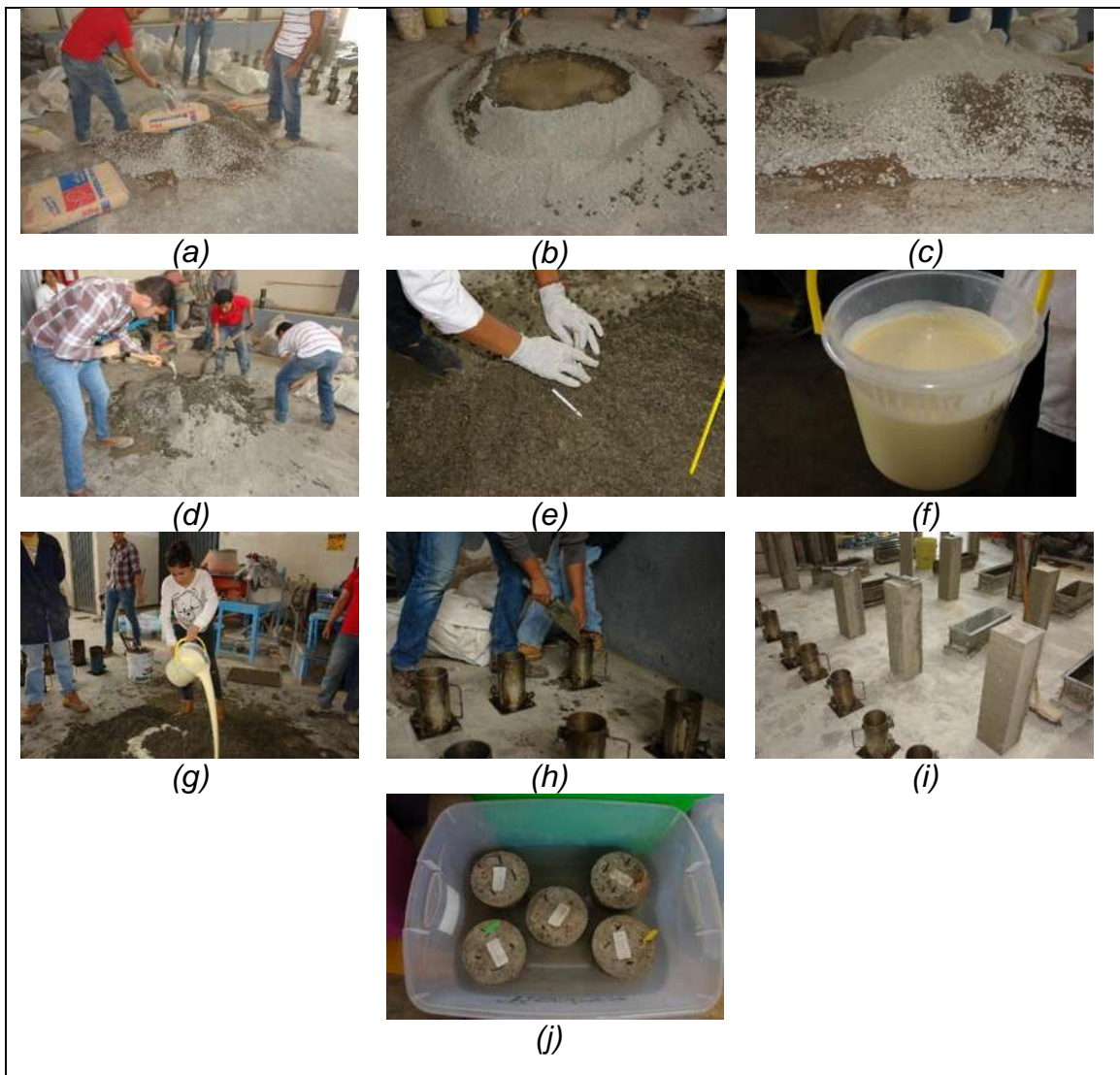
Figura 3.7 Esquema cronológico de elaboración de probetas de concreto; (a) Mezclado de arena grava y cemento, (b) Adición de agua, (c)
