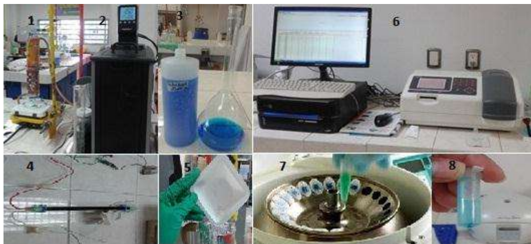
Figura 23. Actividad fotocatalítica con lámpara UV: 1.Fotorreactor utilizado, 2. Recirculador de temperatura, 3. Solución 20 ppm AA9, 4. Lámpara UV, 5. Catalizador, 6. Espectrofotómetro, 7. Centrifuga, 8. Muestra centrifugada
