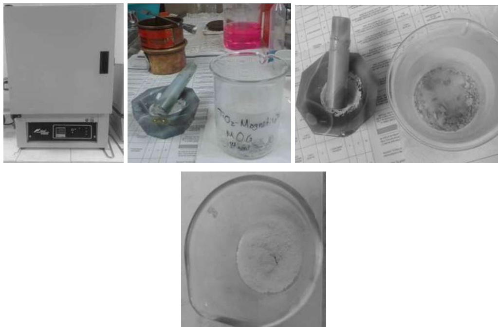
Figura 17. Secado, tritución en mortero de ágata y tamizado de los catalizadores.
