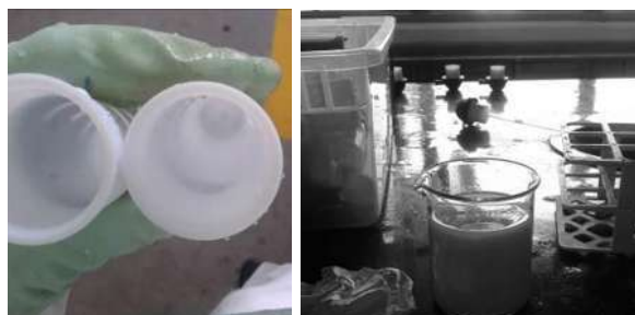
Figura 16. Viales utilizados para la síntesis en el Reactor de microondas y síntesis obtenida
