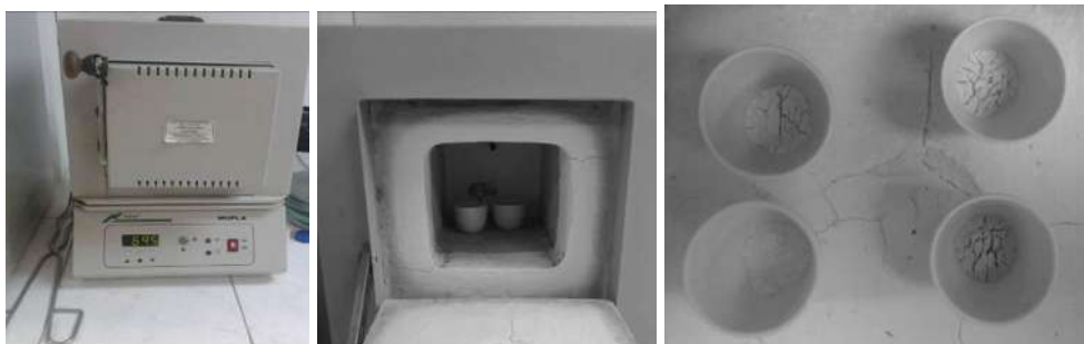
Figura 19. Mufla para tratamiento térmico de los catalizadores obtenidos
