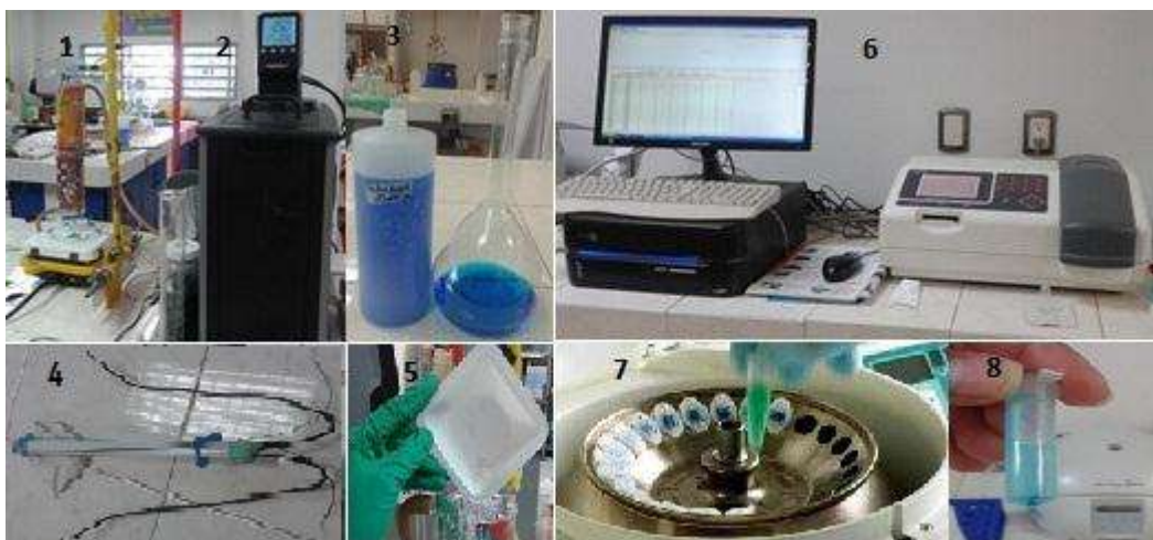
Figura 24. Actividad fotocatalítica con lámpara luz visible: 1.Fotorreactor utilizado, 2. Recirculador de temperatura, 3. Solución 20 ppm AA9, 4. Lámpara luz visible, 5. Catalizador, 6. Espectrofotómetro, 7. Centrifuga, 8. Muestra centrifugada. .
