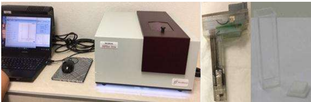
Figura 25. Equipo Brookhaven 90Plus zeta Nano Brook.
