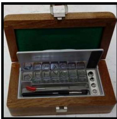
Figura 24. Kit de masas estándar para básculas analíticas.
