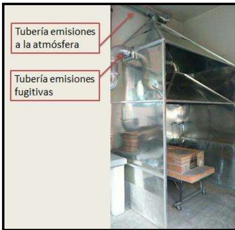
Figura 30. Doble campana para extracción y captura de las emisiones de la chimenea e intra-domiciliarias.
