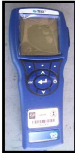
Figura 15. Monitor de las concentraciones de CO y CO 2 .
