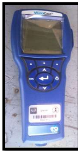
Figura 16. Monitor de velocidad y temperatura.
