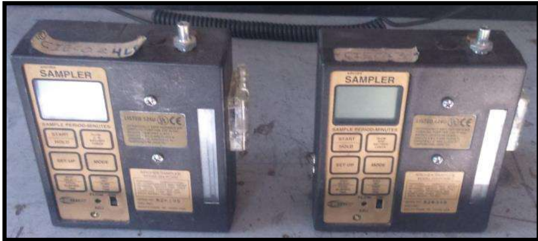
Figura 19. Bombas de succión para la extracción de la muestra.
