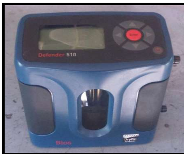
Figura 20. Medidor de flujo.
