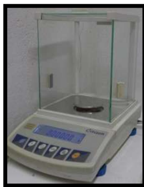
Figura 22. Báscula semi micro-analítica.
