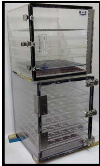
Figura 27. Gabinetes desecadores para filtros.
