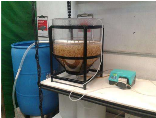
Figura 5.1.- Reactor de lecho móvil piloto, con volumen útil de 40 L
