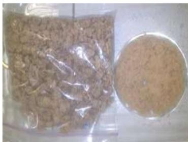
Figura 7. Cartón antes y después del proceso de molienda mecánica.
