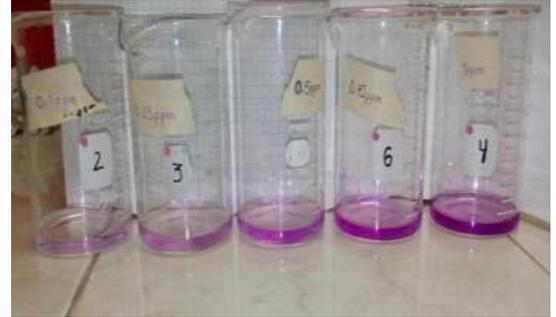
**Figura 30. Curva de calibración para la determinación de Cr (VI) por espectrofotometría UV-Vis.**
