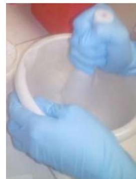
Figura 9. Fibrilación mediante molienda con nitrógeno líquido.
