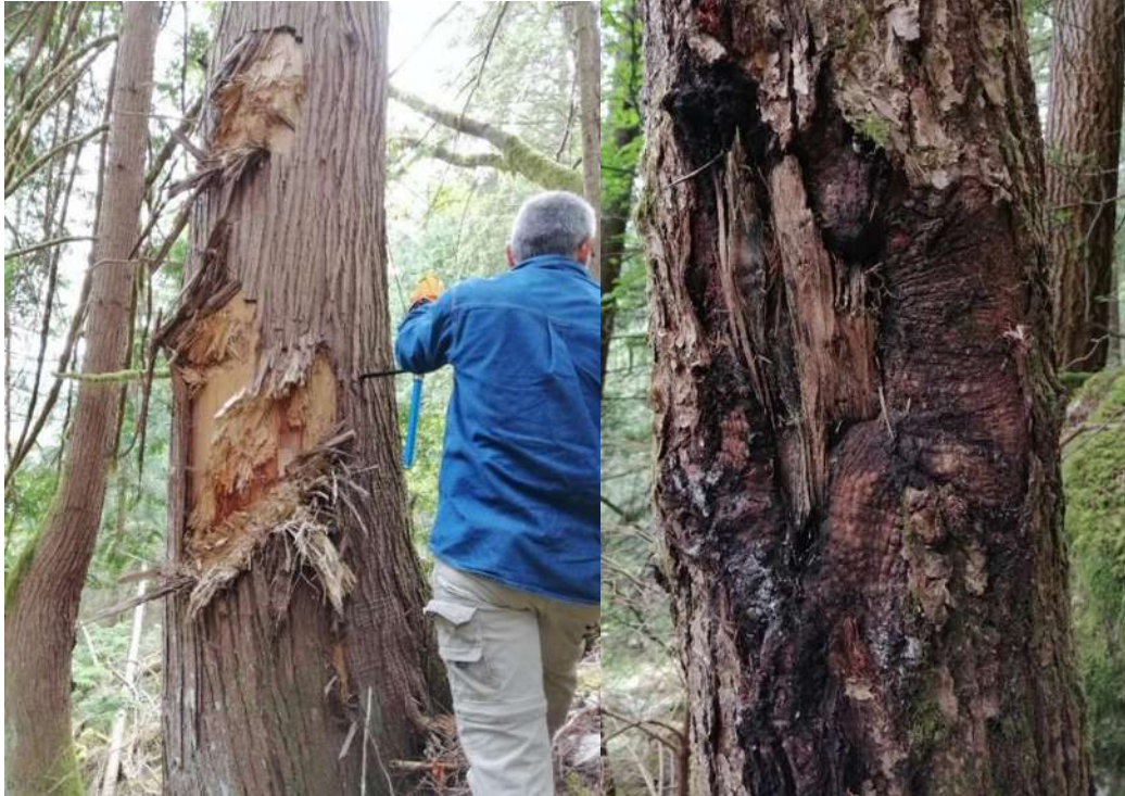
Figura 16. Muestreo dendrocronológico, árbol dañado por evento reciente que generó la remoción subsuperficial de la corteza en al menos cuatro zonas del árbol a diferentes alturas, además, muestra una ligera inclinación ladera abajo (a), árbol con daño antiguo evidente por medio de un callo evidente con secciones donde aún se presenta resina fresca (b).
