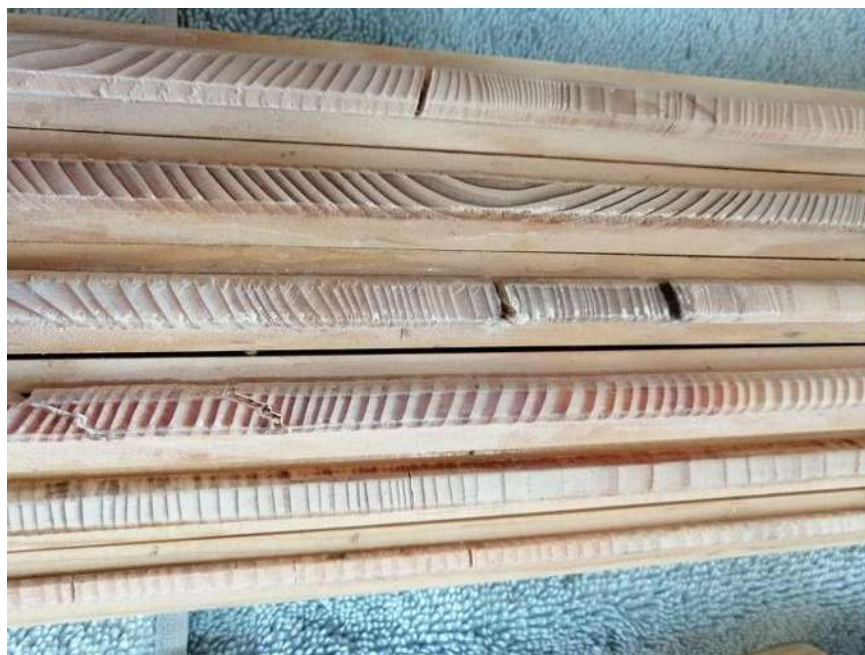
Figura 17. Muestras dendrocronológicas lijadas y pulidas
