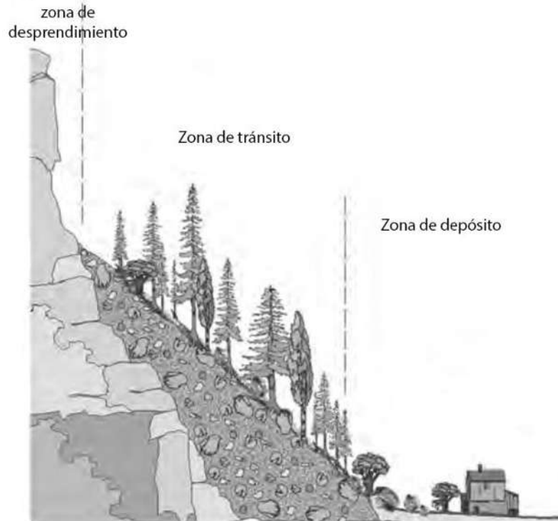
Figura 3. Zonificación de la caída de roca desde su punto de desprendimiento. (Modificado de Dorren et al., 2007).
