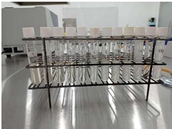
Ilustración 21. Concentración mínima inhibitoria del material  $Ag/Ti_{0.96}Ce_{0.04}O_2$
