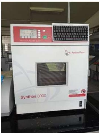
Ilustración 2. Reactor de microondas Anton Paar Synthos 3000
