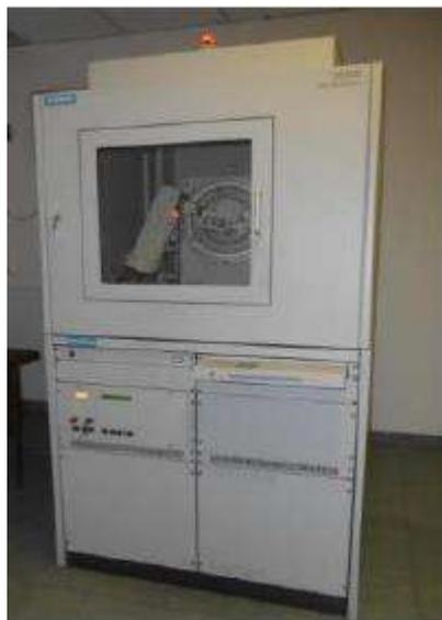
Ilustración 4. Difractómetro de rayos X SIEMENS modelo D-500 usando un ánodo de cobre con radiación  $\text{CuK}\alpha$  ( $\lambda=1.54 \text{ nm}$ )
