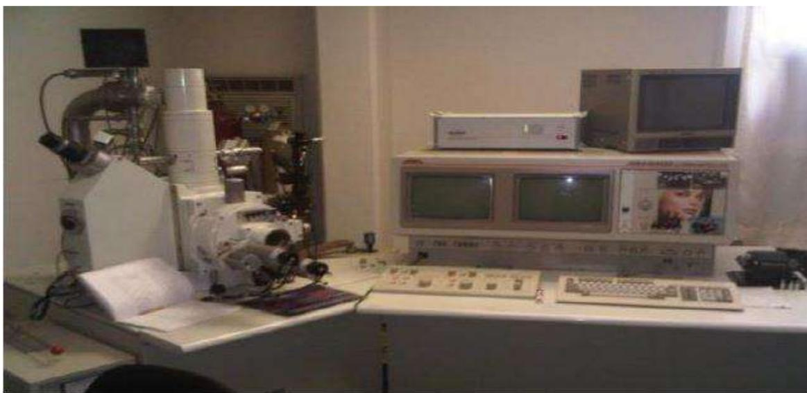
*Ilustración 5. Microscopio electrónico de barrido*
