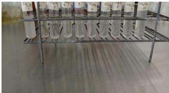
Ilustración 25. Determinación de concentración mínima inhibitoria del material Ag/TiO<sub>2</sub>
