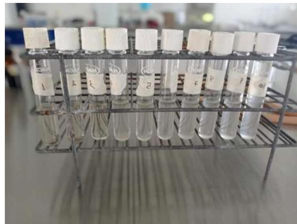
Ilustración 22. Concentración mínima inhibitoria del material  $Ag/Ti_{0.98}Ce_{0.02}O_2$
