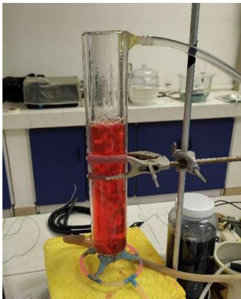
Ilustración 13: Reactor para pruebas de fotocatalisis.
