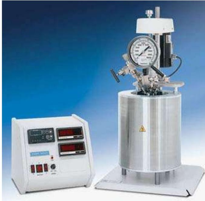
**Figura 3.2 Reactor Parr Instruments empleado en el estudio de hidroconversión del 2-metilnaftaleno.**
