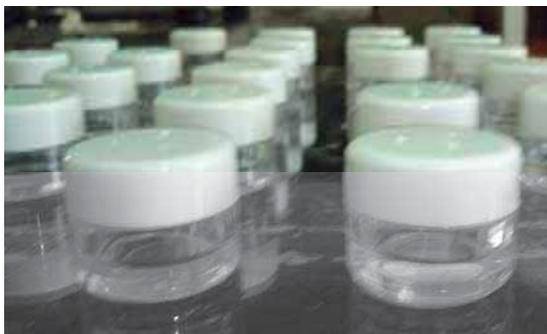
**Figura 3.3. Muestras de SiO<sub>2</sub> en proceso de gelación.**
