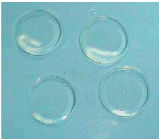
**Figura 4.2. Monolitos de  $\text{SiO}_2$  después del proceso de secado.**
