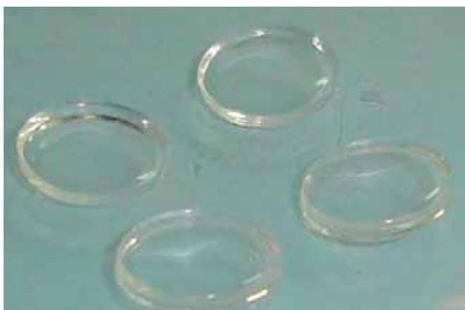
**Figura 4.3. Monolitos de  $\text{SiO}_2$  después del proceso de calcinación.**
