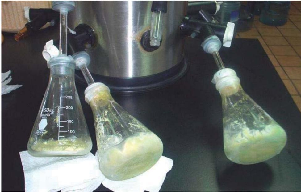
Figura 2.3.1 Muestra de Aguacate Liofilizándose
