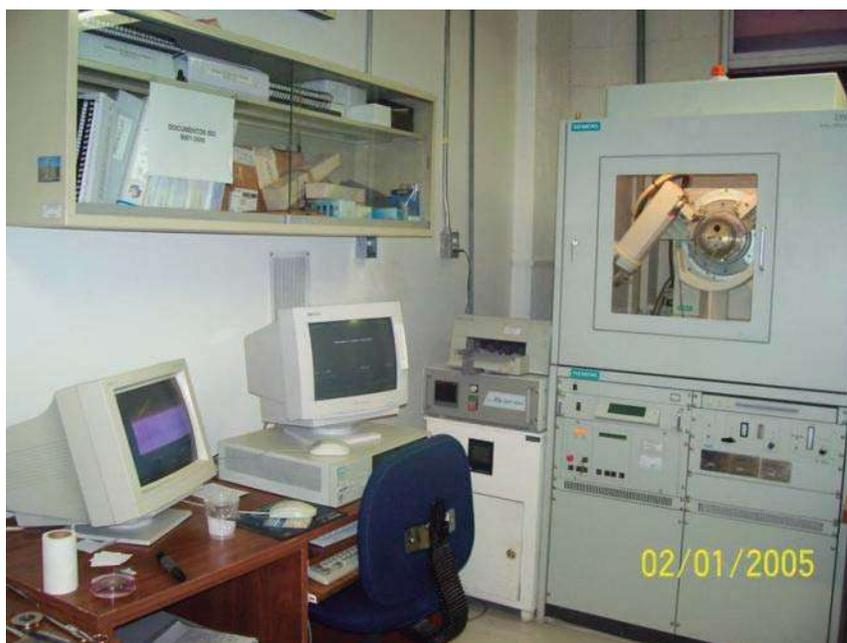
Figura 3.11 Imagen del difractómetro de rayos X D5000 Siemens.
