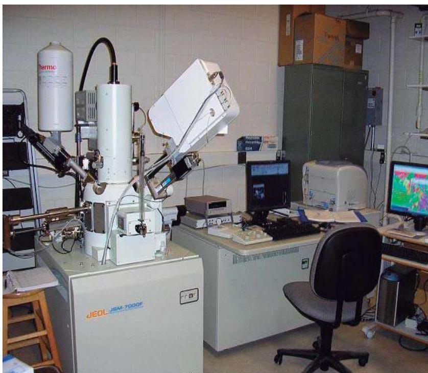
**Figura 3.14 Microscopio Electrónico de Barrido (SEM).**
