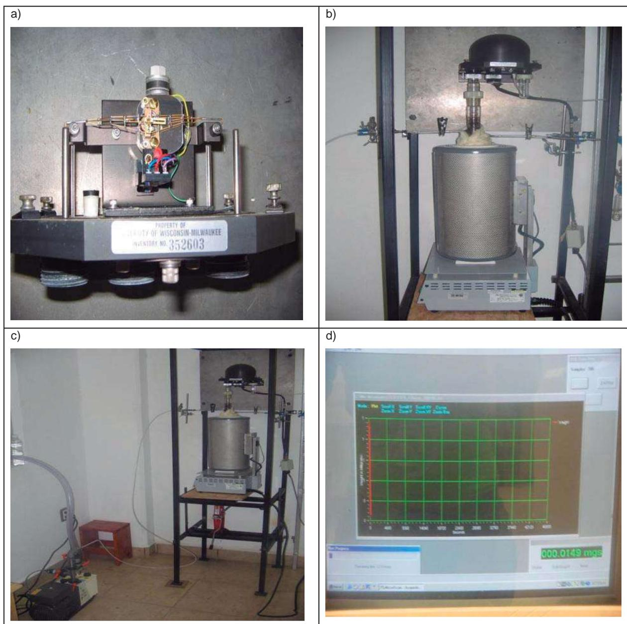
Figura 3.5 Componentes del equipo experimental, a) unidad de medición de peso, b) horno empleado para modificar las temperaturas, c) sistema conectado a la bomba de vacío y d) software de adquisición de datos del crecimiento de películas.
