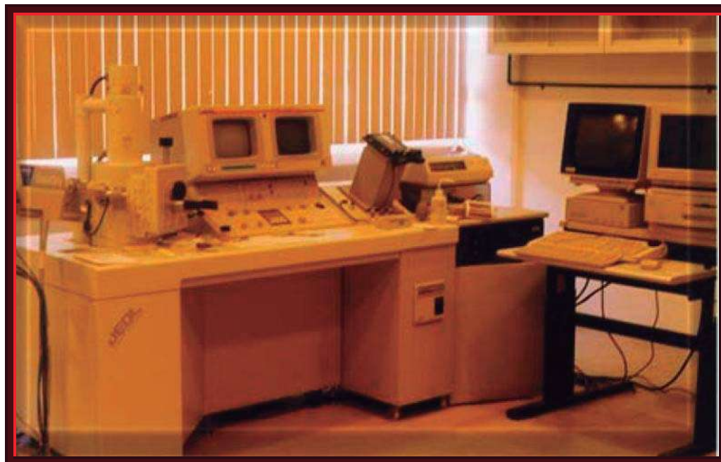
Figura 33 Microscopio electrónico de barrido con analizador de energía dispersiva integrado.
