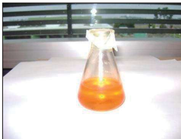
Figura 4.23. Solución indicativa de la reducción de 2,4-dinitrofenilhidrazina con la presencia de formaldehído utilizando los materiales 3ST12P.
