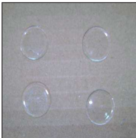
Figura 4.3. Monolitos de SiO 2 obtenidos con velocidad de calentamiento de 2.5°C/min.
