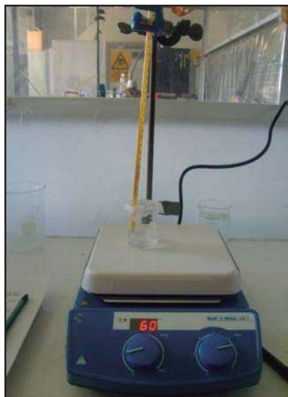
Figura 4.1. Sistema de síntesis de los monolitos de SiO 2 .
