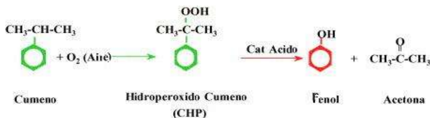
Figura 5.1 Reacción de obtención de fenol a partir de cumeno.
