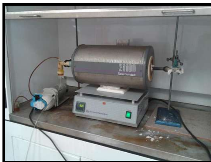
Figura 12 Imagen del proceso de síntesis de los NTC.
