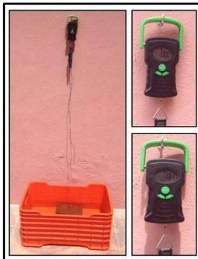
**Figura 4.22.-** Determinación del peso ahogado de los ladrillos.
