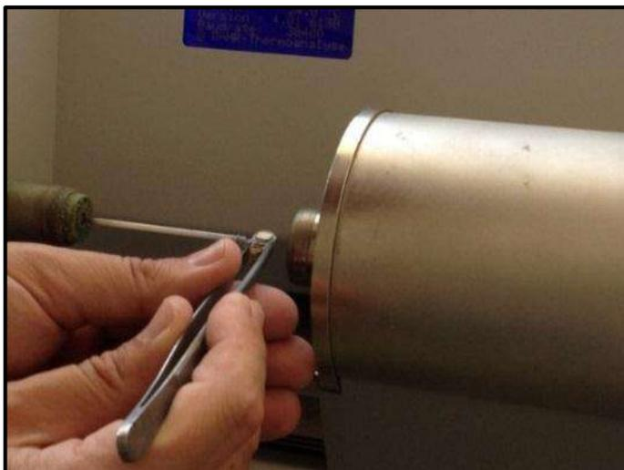
**Figura 4.15.-** Muestra de RSA en la termobalanza.
