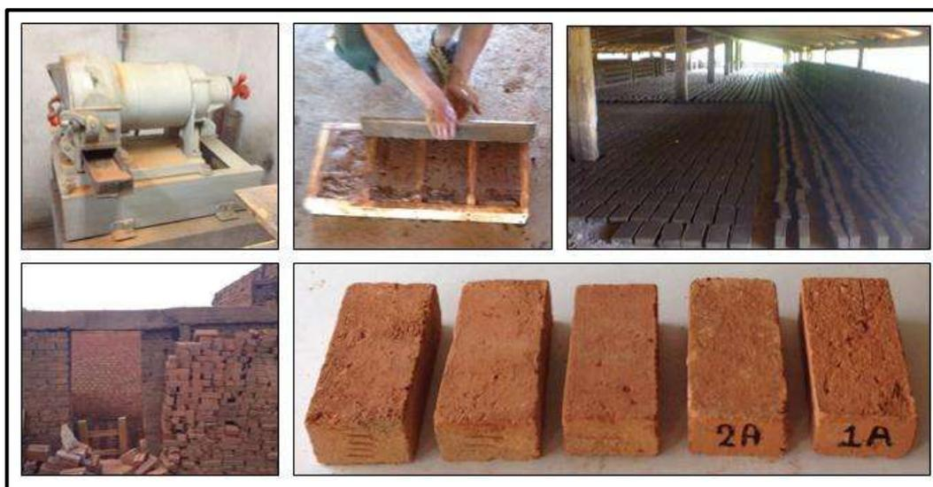
**Figura 4.21.-** Proceso de elaboración de ladrillos en base al RSA.
