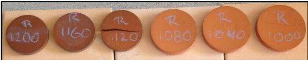
**Figura 5.5.-** Piezas de RSA a diferentes temperaturas de cocción.
