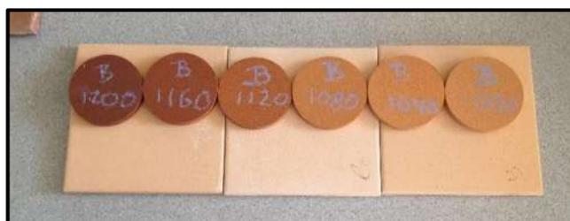
**Figura 5.18.-** Piezas del BN sometidas a un proceso de cocción a temperaturas de 1100°C a 1200°C.
