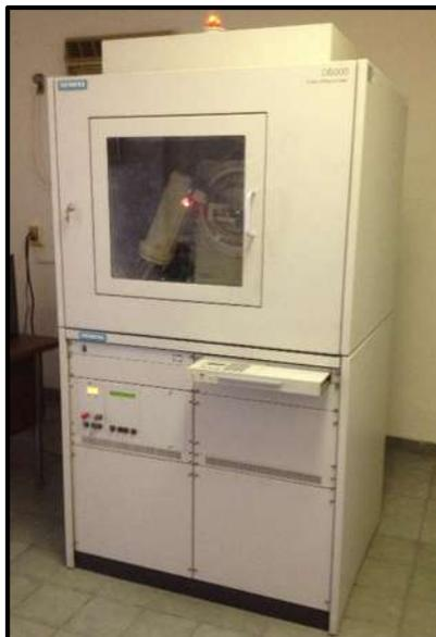
**Figura 4.5.-** Difractómetro de Rayos X SIEMENS D5000.
