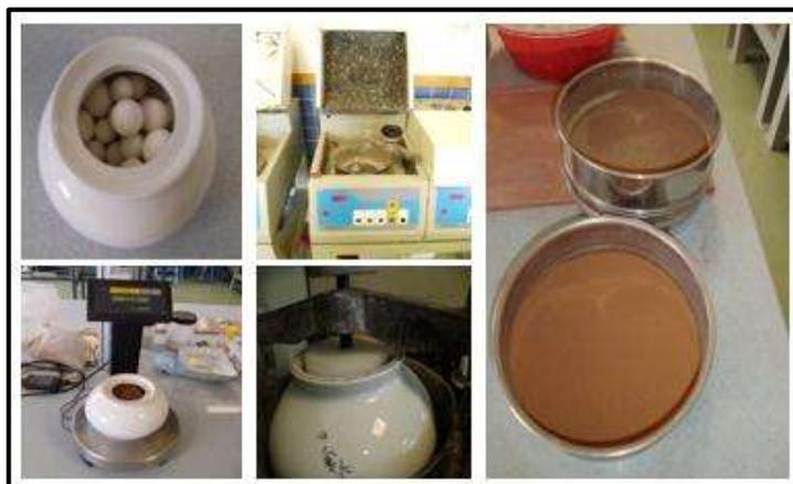
**Figura 4.2.-** Molienda y tamizado del RSA.
