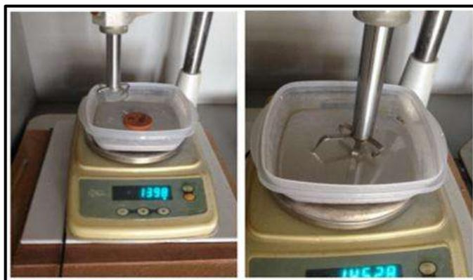
Figura 4.11.- Pieza del RSA sumergida en Mercurio.
