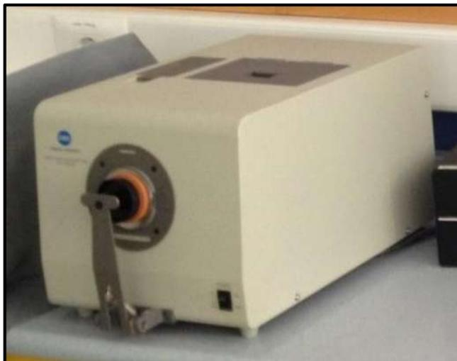
**Figura 4.14.-** Muestra del RSA en el espectrofotómetro MINOLTA D8000.
