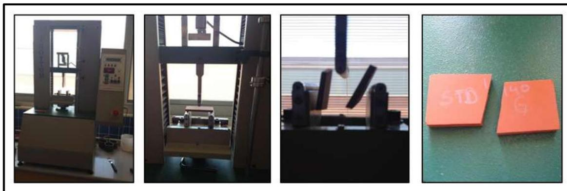
**Figura 4.16.-** Ensayo de resistencia mecánica a la flexión.
