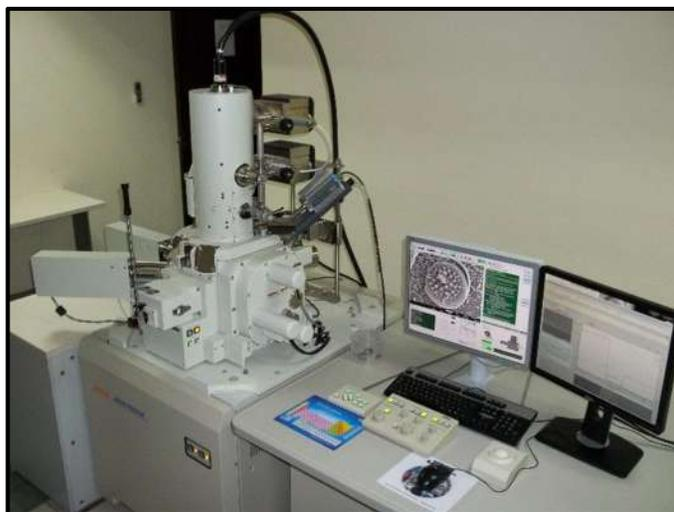
**Figura 4.6.-** Microscopio Electrónico de Barrido de emisión de campo JEOL JSM-7600F.
