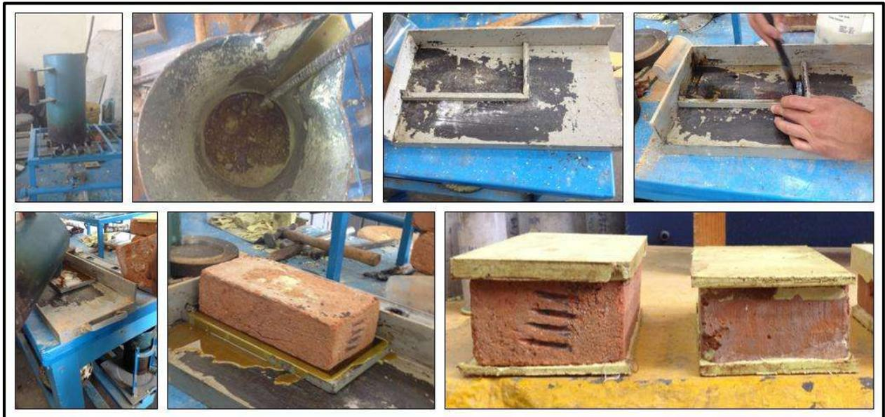
**Figura 4.24.-** Colocación del mortero de azufre a los ladrillos.
