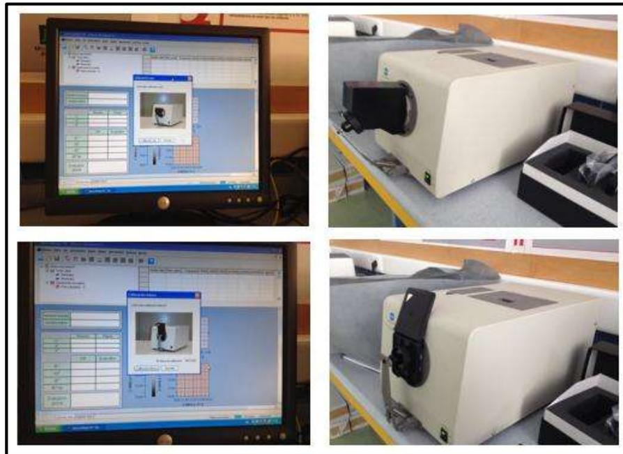
**Figura 4.13.-** Calibración del espectrofotómetro MINOLTA D8000.
