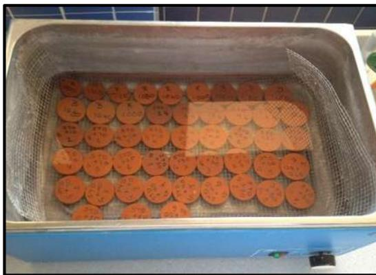
**Figura 4.10.-** Absorción de agua de piezas cocidas del RSA.
