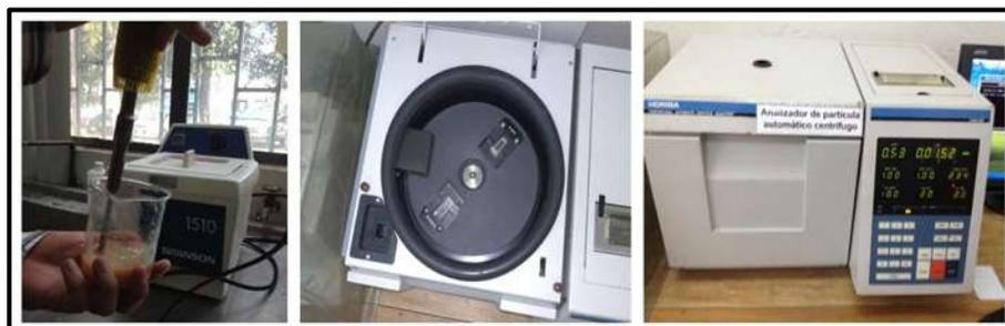
**Figura 4.3.-** Ensayo DTP en un analizador de partícula automático centrífugo.
