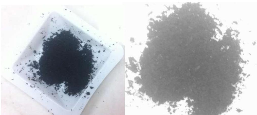
**Figura 4. 1 Nanotubos de carbono (NTC).**
