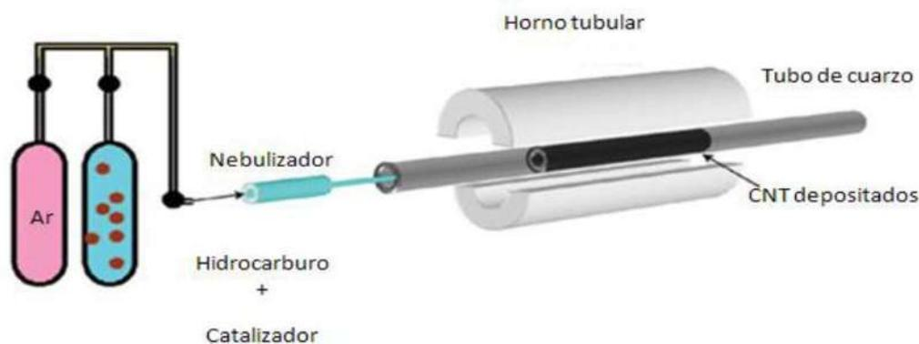
**Figura 2.5 Método de rocío pirolítico para la síntesis de nanotubos.**
