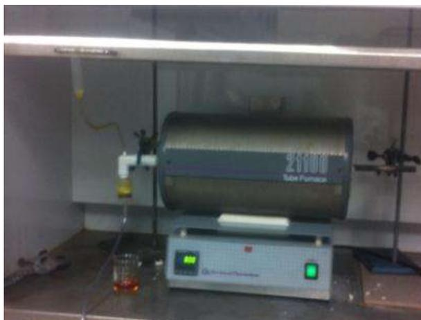
**Figura 3. 2 Síntesis de nanotubos de carbono.**
