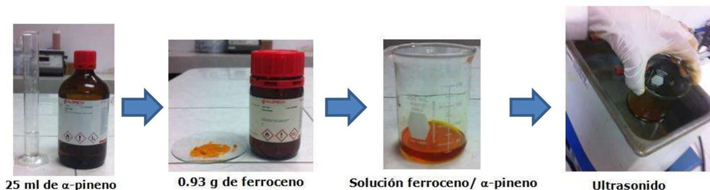
**Figura 3. 1 Preparación de la solución ferroceno/ $\alpha$ -pineno.**
