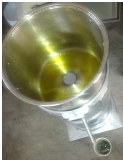
FIGURA 5-17. OBTENCIÓN DE ACEITE MEDIANTE CENTRIFUGACIÓN
