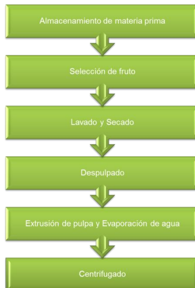
FIGURA 4-1. PROCESO GLOBAL DE EXTRACCIÓN DE ACEITE EXTRA VIRGEN DE AGUACATE
