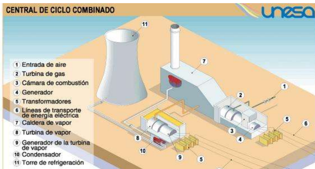
Figura 6. Diagrama de proceso de una central de ciclo combinado.
