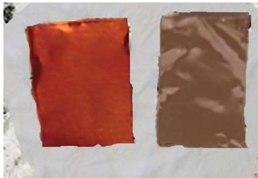
Fotografía comparativa entre lámina de cobre con depósito de grafeno y sin depósito Lado izquierdo: lámina de cobre con capa superficial de óxido con flujo de 250 sccm de Ar Lado derecho: lámina de cobre con grafeno obtenido con flujo de 500 sccm de Ar
