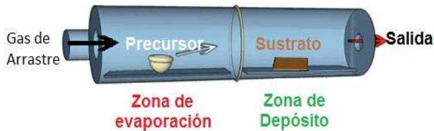
Figura 3. Esquema de la técnica de PVD
