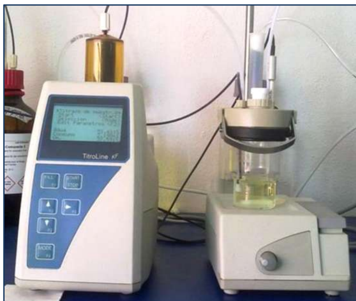
Figura 14. Equipo de titulación Karl Fischer TitroLine
