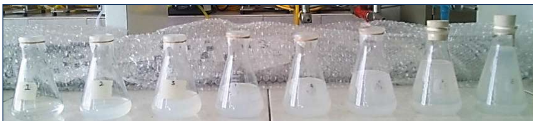
Figura 6. Representación física del proceso de precipitación salina por acción de la acetona
