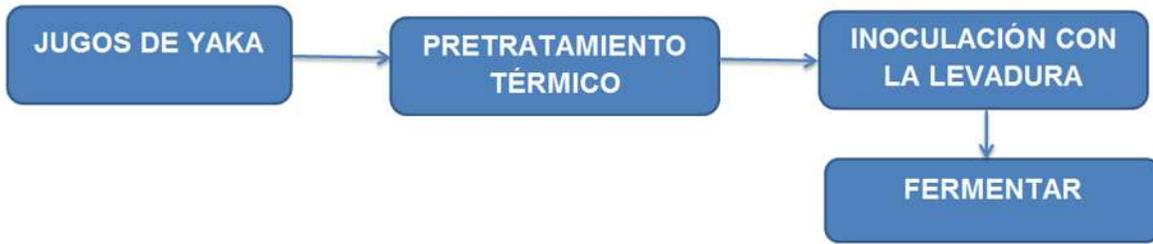
**Figura 3.2** Diagrama de bloques de la producción de Bioetanol de primera generación.
